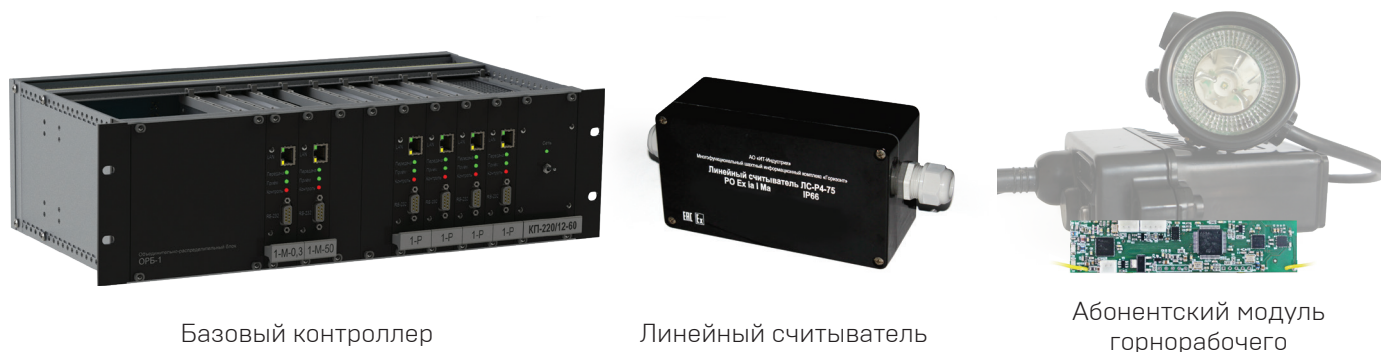
Рис. 1 Основные элементы сети позиционирования и аварийного оповещения комплекса «Горизонт»
