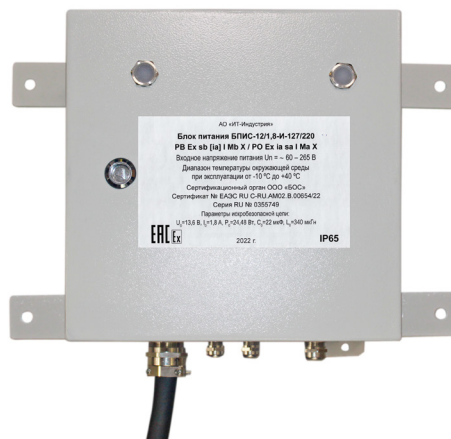
Рис.8 Блок питания искробезопасный, серия «БПИС» (применяется в шахтах и рудниках, опасных по газу и пыли)
